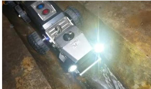
これまで作業員が危険な下水道管内で行っていた調査・清掃を自社開発の「自走式ロボット」の導入によって、安全かつ効率的な管内作業を実現しております。
