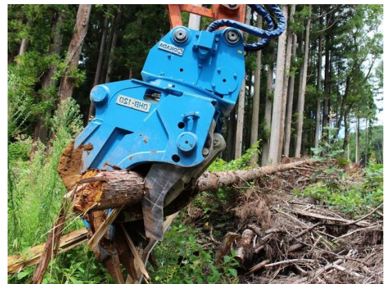
林業機械 (ハイブリッドバケット) 林業・土木作業用複合アタッチメント。 樹木の伐倒・集積や造成作業を1台で対応 し、林道などの路網整備に適しています。
