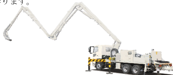
電動コンクリートポンプ車 「ツインドライブピストンクリート」
