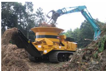
バイオマス発電用 木材破砕機
