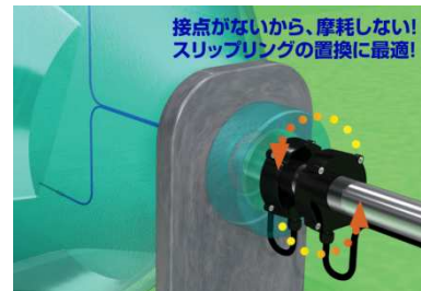
ワイヤレスにより回転部の 摩耗を除去
