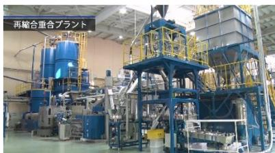
メカニカルリサイクルによる日本初の「ボトル to ボトル」を実現した再縮合重合プラント
