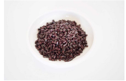
資源循環を目的とした、衣料 品製造の課程で発生する生地 裁断くずのペレット化
